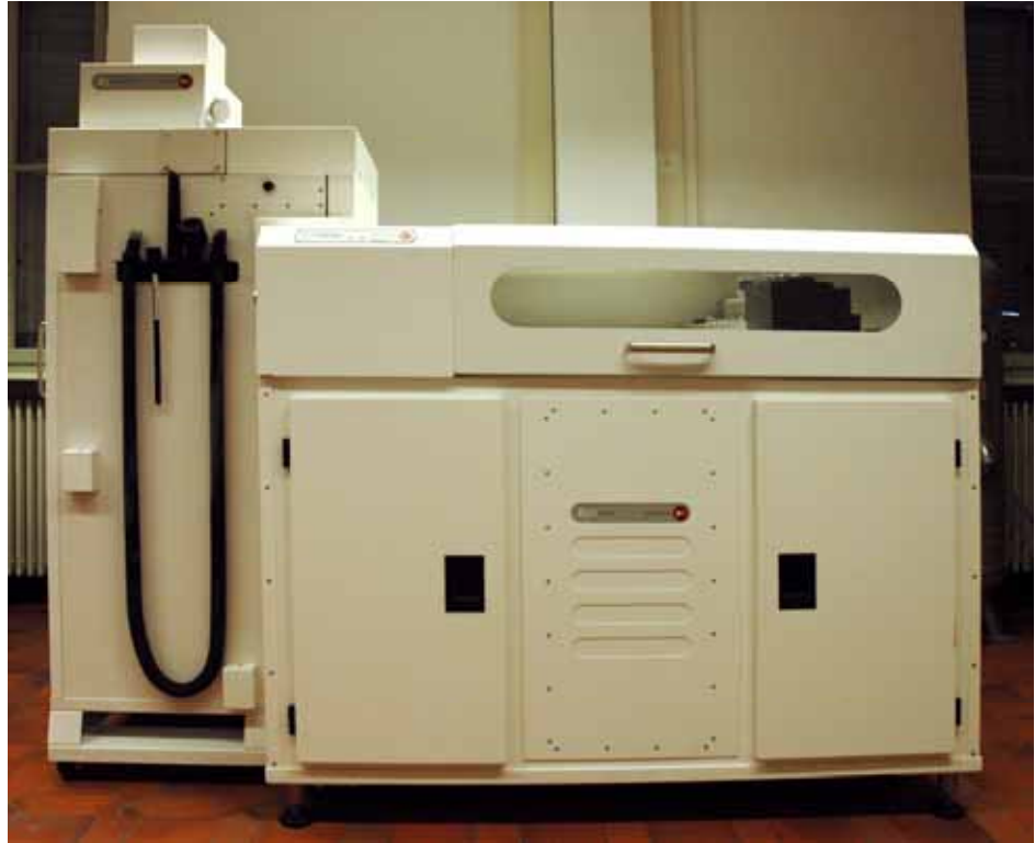
Fig. 19: Prototipazione rapida; la stampante 3D i.CUP – Zcorp 810 è in grado di realizzare modelli reali fissando polvere di gesso su strati sovrapposti (500 x 600 x 400 mm dimensioni massime)
