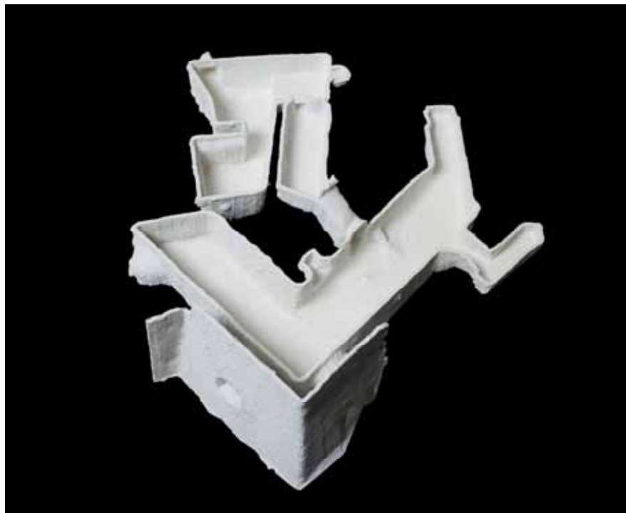
Fig. 22: Modello tridimensionale reale sezionato dello spazio interno, stampato presso i.CUP con stampante Z-Print 810 (scala 1 : 100)
