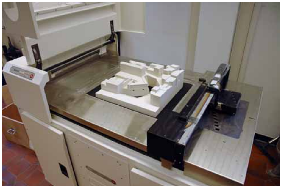
Fig. 20: Prototipazione rapida; realizzazione di un modello reale a partire dalla ricostruzione virtuale con la stampante 3D i.CUP – Zcorp 810
