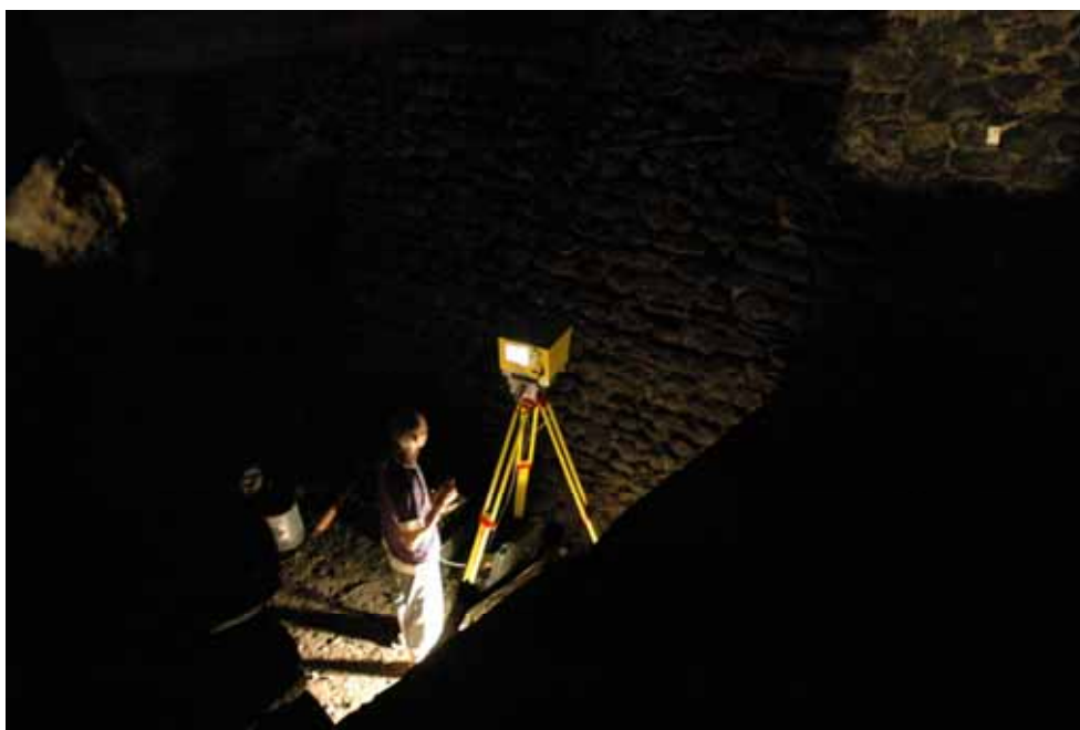
Fig. 7: Esecuzione del rilievo; fotografia dello spazio interno del rivellino e dello strumento Optech ILRIS 3 o D durante una scansione
